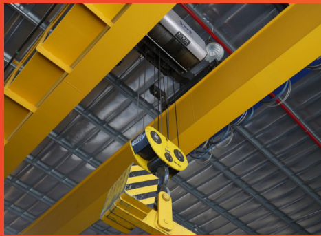
Puente grúa birraíl
